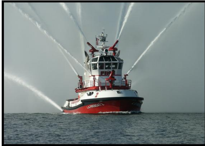
Fig. 3: Embarcação de Combate a Incêndio e SOS ( Fire Fighting )
