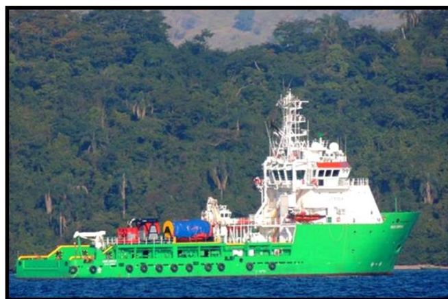
Fig. 6: Embarcação OSRV ( Oil Spill Response Vessel )
