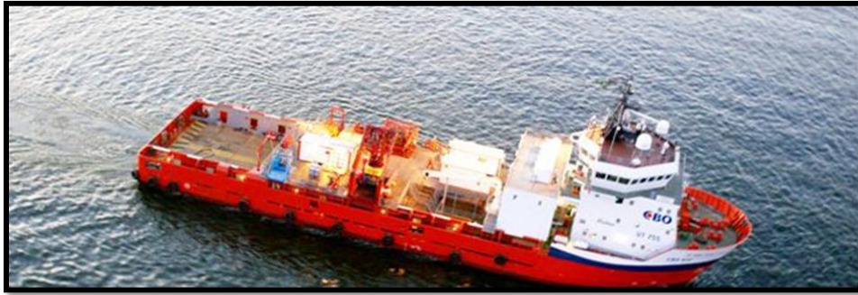
Fig. 10: Embarcação de Suporte a ROV – Veículo de Operação Remota (ROV Support ) (Fonte: Citrosuco)
