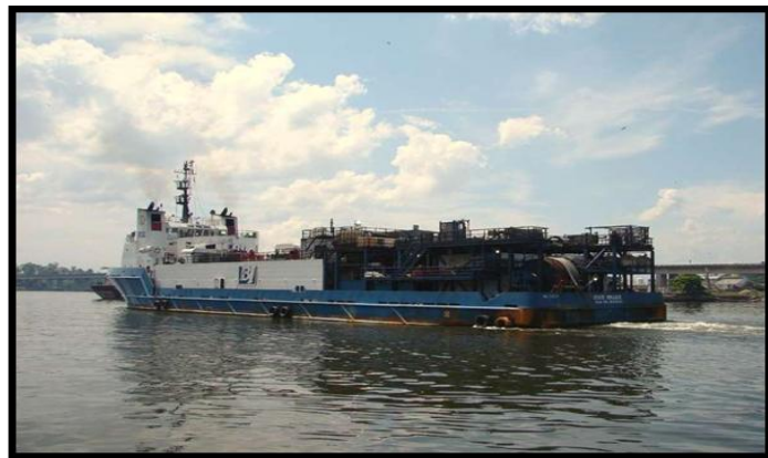
Fig. 4: Embarcação de Estimulação de Poços ( Well Stimulation Vessel )
