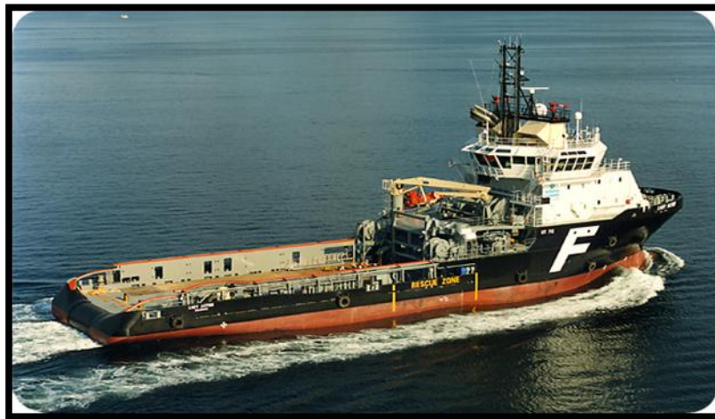
Fig. 2 - Embarcação AHTS ( Anchor Handling Tug Supply ).
