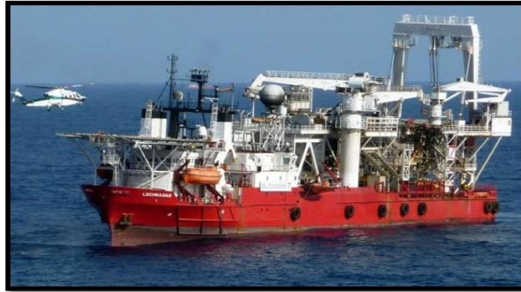
Fig. 5: Embarcação de Lançamento de Linha (PLSV – Pipe Laying Support Vessel )
