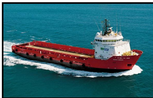
Fig. 1: Embarcação PSV ( Platform Supply Vessel )
