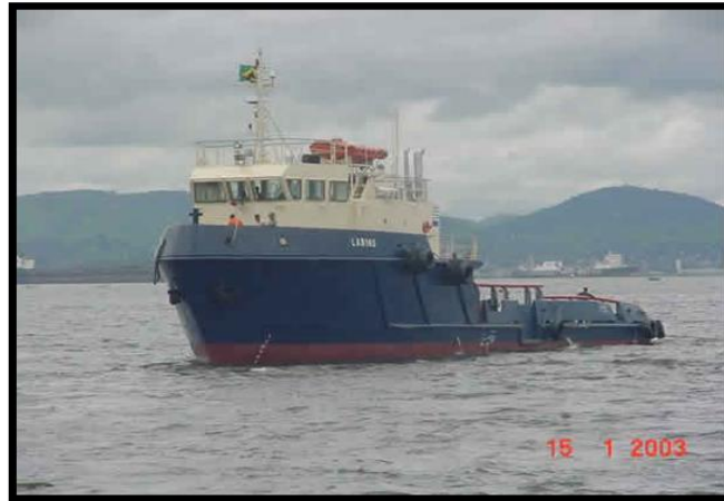
Fig. 7: Embarcação de Manuseio de Espias ( Line Handling )
