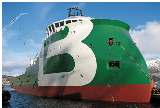
Figura 14: Bourbon Orca: Primeira embarcação a utilizar a proa X-Bow
