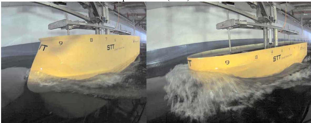
Figura 15: Ilustração mostrando o impacto de uma onda em uma proa X-Bow (a esq.) e em uma proa comum (a dir.)
