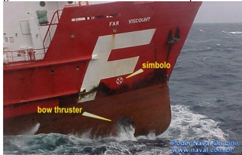
Figura 9: Mostrando um Bow Thruster e seu respectivo símbolo
