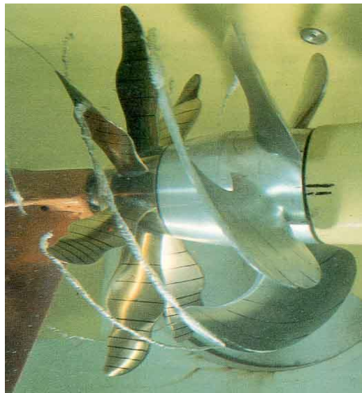
Figura 9 – Cavitação gerada pelo Hélice (Fonte: Brenner 1995)
