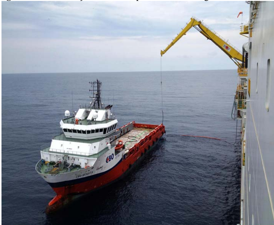
Figura 12: Embarcação Fluideira operando com mangote conectado
