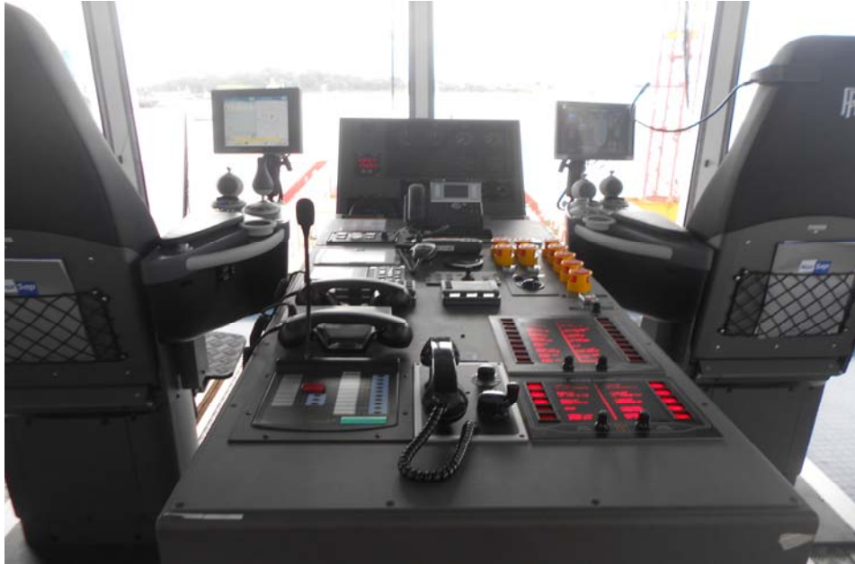
Figura 2: Console de Ré de DP Classe 2 – CBO Arpoador
