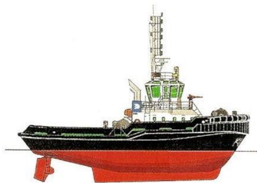
Rebocador Azimutal com propulsão a ré.
