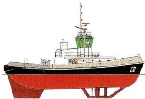
Rebocador Cicloidal com propulsão a vante.
