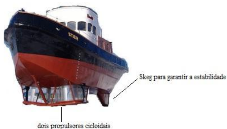
Figura 4 – Propulsor trator com propulsão cicloidal
