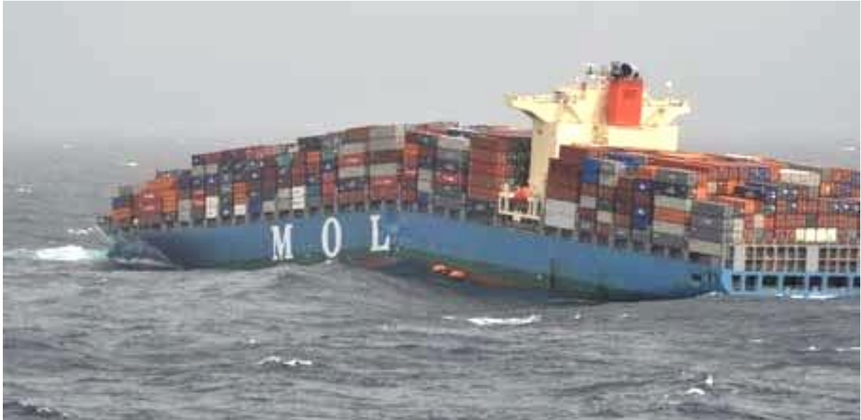
Figura 29- Alquebramento por mau planejamento do plano de carga
