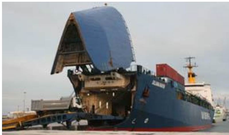
Figura 7 – Navio Ro/Ro do tipo multi-purpose
