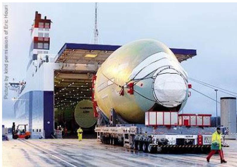
Figura 17 – Heavy lift sendo carregado em um navio Ro/Ro
