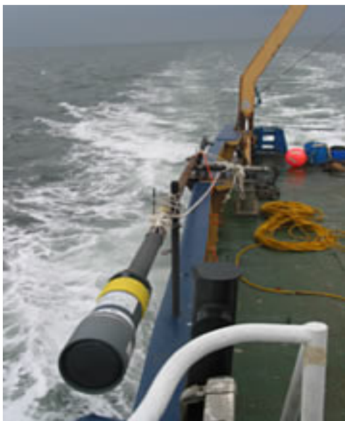
Figura 13 Over the side pole. É arriado no mar quando o sistema acústico é utilizado.
