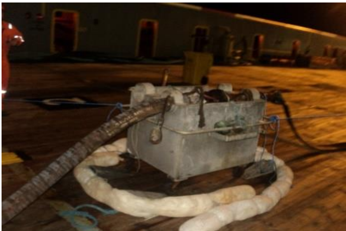
Figura 32: Carrinho de contenção com mangueira conectada pronto para iniciar transferências
