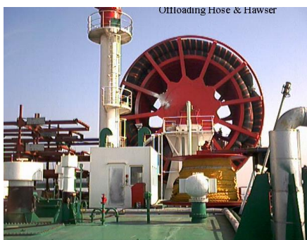
Figura 10 - Sarilho de Armazenamento de Linha de Mangotes
