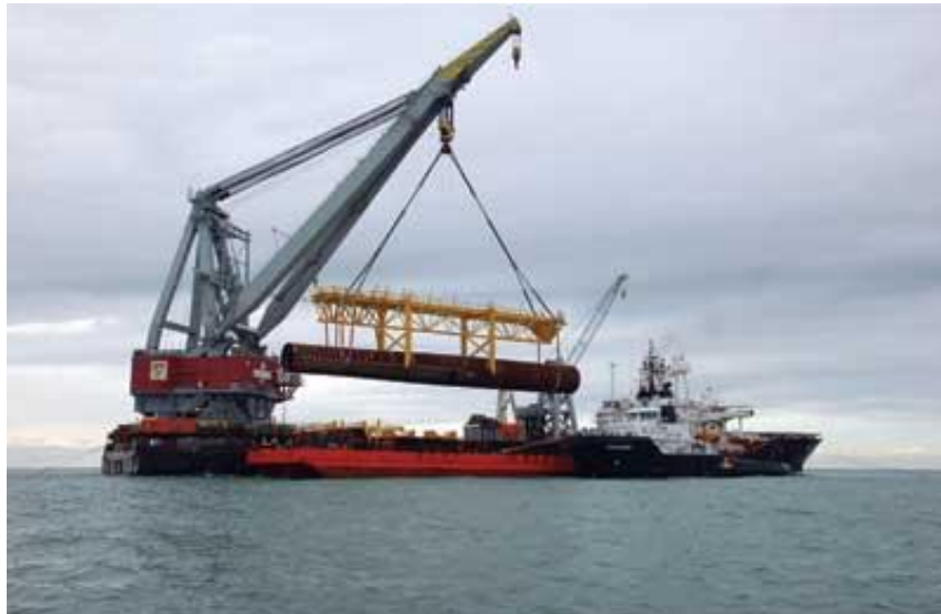
Figura 20 - Balança de Manuseio de Mangotes
