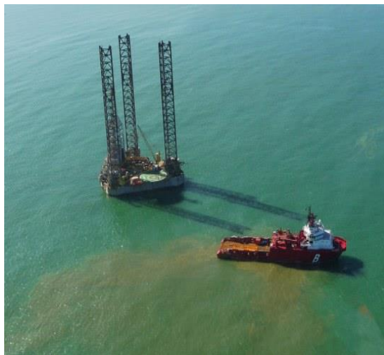
Figura 3 - Plataforma Auto Elevatória
