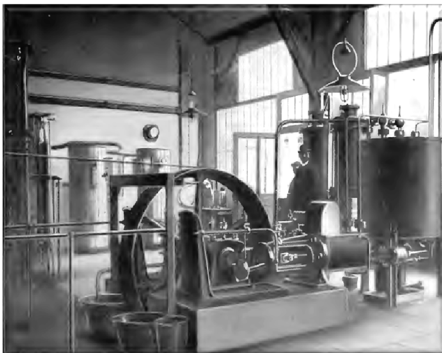
Figura 96 - Vista de uma instalação de oxigênio puro no sistema Linde pertencente à M. Bardo, de Paris. Capacidade de produção de 20 metros cúbicos por hora
