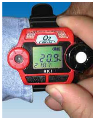
Figura 8 - Detector de gás de pulso.
