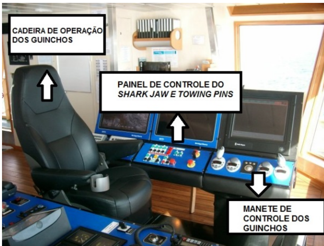
Figura 16 – Detalhe do Console de Controle dos Guinchos.
