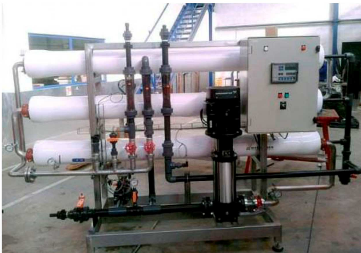
Figura 5 – Equipamento de dessalinização por osmose reversa horizontal
