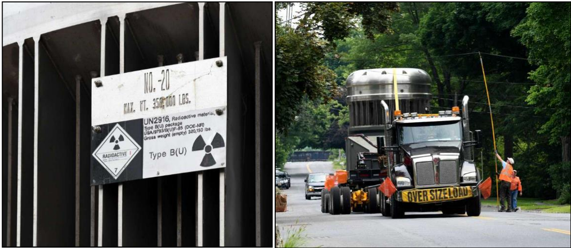
Figura 14a e 14b – Exemplo de um contêiner do Tipo B, para combustível nuclear irradiado (M-140), transportado por via rodoviária. No detalhe (a), a sinalização do contêiner.
