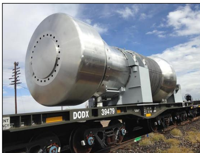
Figura 10 – Exemplo de um contêiner do Tipo B para combustível nuclear irradiado, utilizado em sistemas de propulsão naval da US Navy (M-290), com 260 toneladas e 9,2m de comprimento, transportado por linha ferroviária. Em suas duas extremidades, os domos limitadores de impacto.
