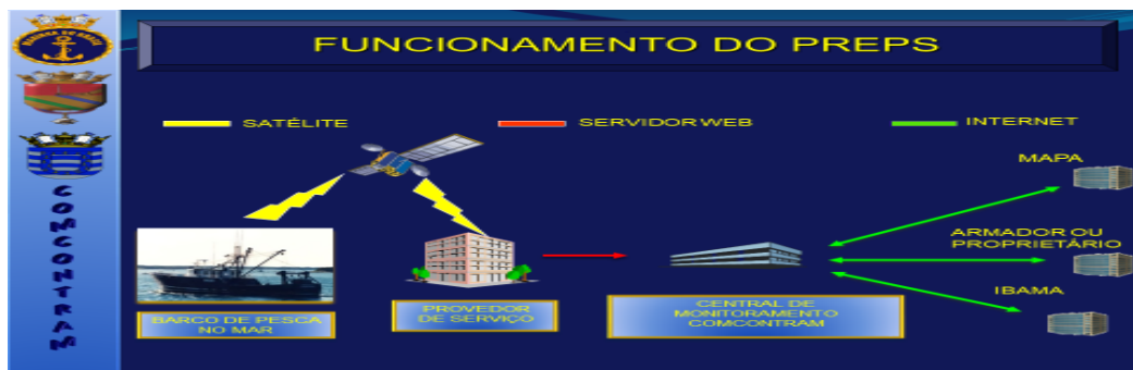
FIGURA 14 – Esquema simplificado de funcionamento do sistema PREPS (COMCONTRAM, 2016a).
