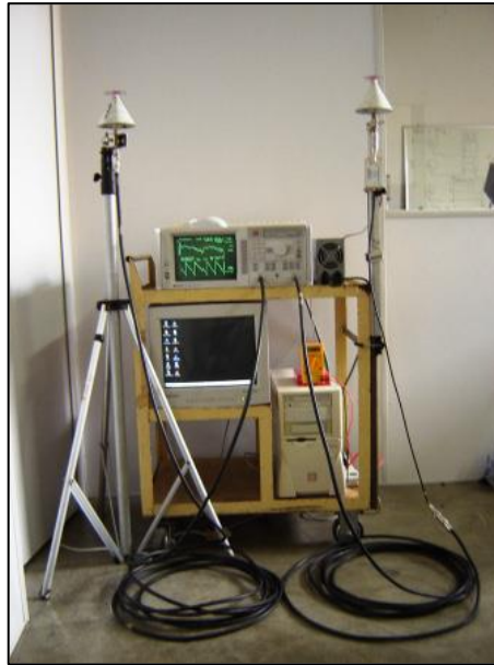
Fig. 4.4 - Setup utilizado na sondagem pelo método da varredura em frequência [20].
