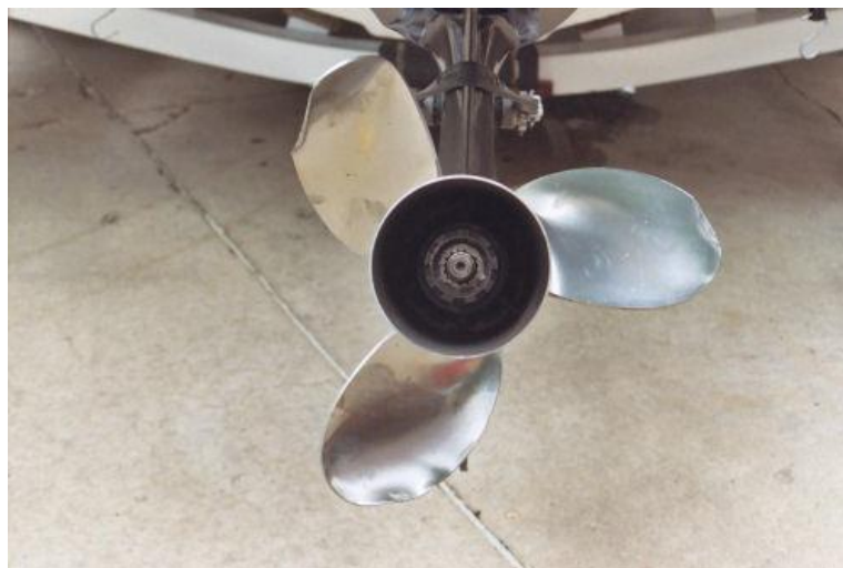
Figura 42: bordo de fuga da pá do propulsor com dobra causado por cavitação
