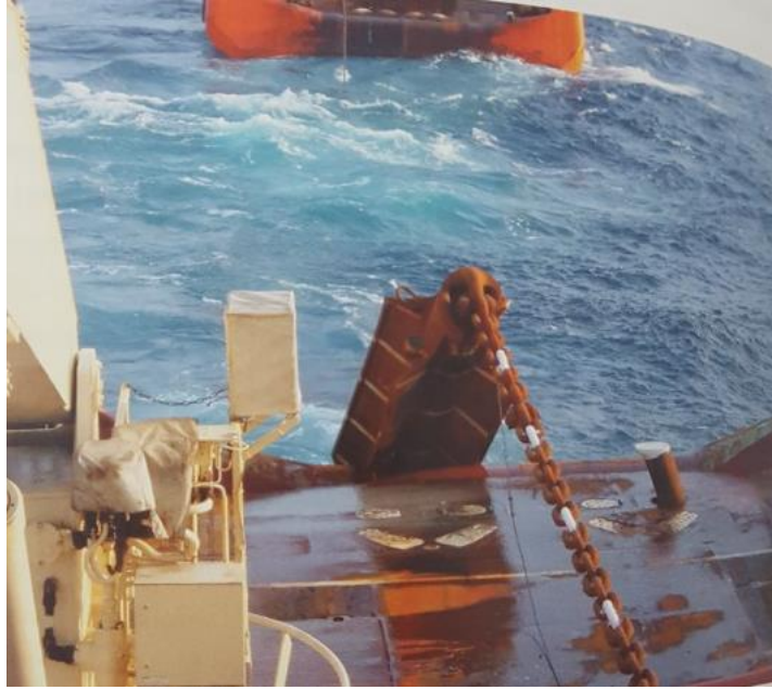
Figura 3: Estaca torpedo sendo lançada por um AHTS Fonte: Gibson (2009)
