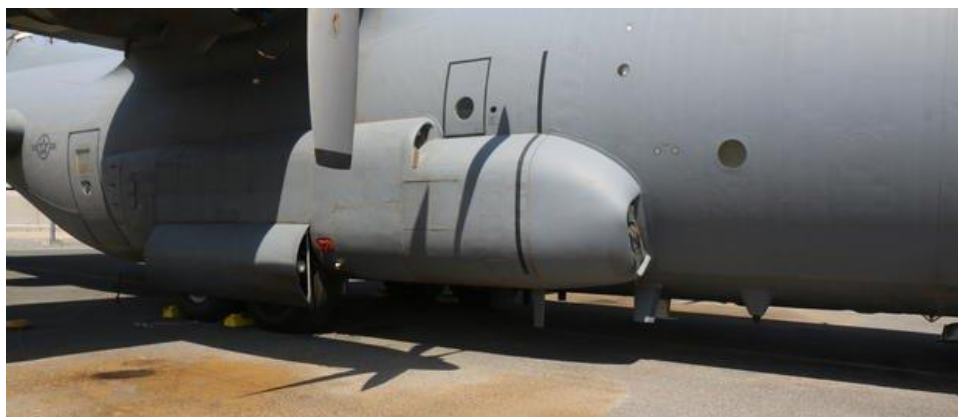
Figura 6.7 - EC-130H possui antenas (sob a fuselagem),
