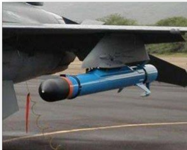
Figura 5.7 – Sistema de MAE instalado na configuração POD em uma aeronave
