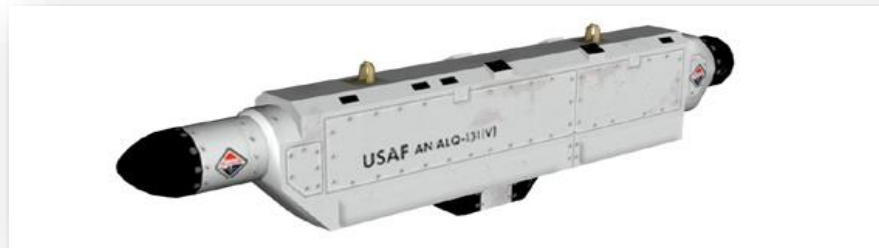
Figura 5.9 - AN/ALQ-131 utilizado nas aeronaves F-16, F-111, A-10, F-4, F-15, F-5 e C-130.
