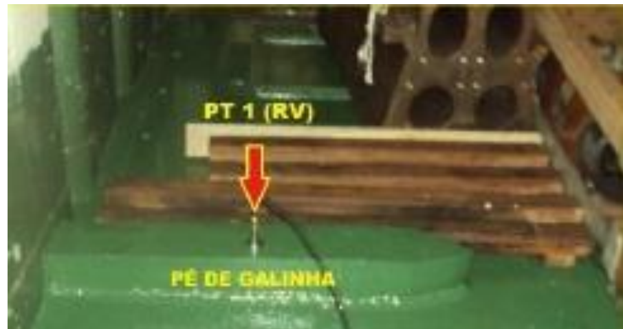
Figura 10 – Foto do ponto de instalação do acelerômetro
