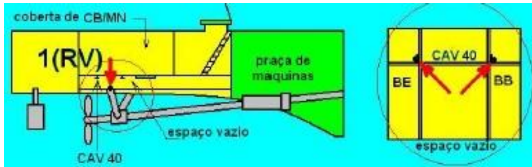
Figura 13 – Croqui dos pontos de medição das Linhas de Eixo.
