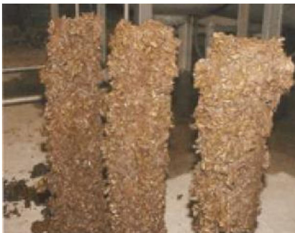
Figura 6: Filtros obstruídos pelo molusco
