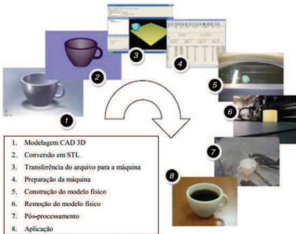
Figura 13: Etapas do processo de impressão 3D
