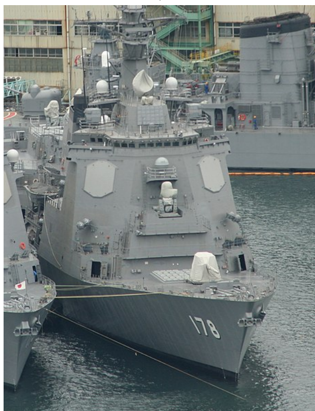
Figura 5.6: Painéis das antenas do radar AN/SPY-1D (V) octogonais cinza claro localizados na frente da superestrutura do navio japonês JS Ashigara (DDG-178)
