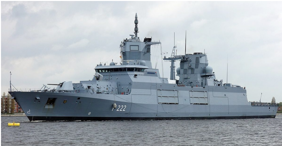
Figura 5.10: Fragata F222 Baden-Württemberg, equipada com o radar TRS-4D com antenas fixas
