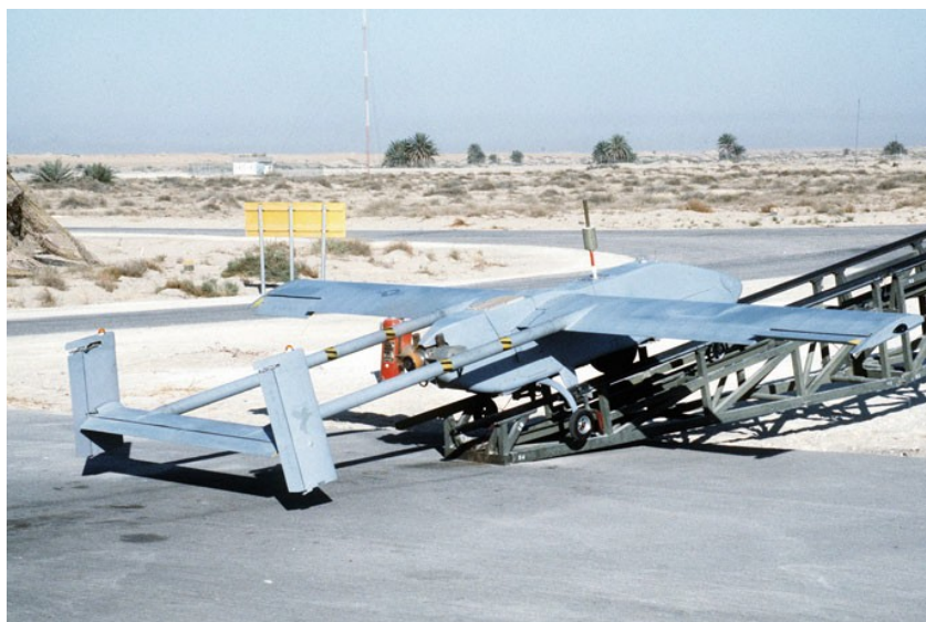
Figura 13: Um Pioneer RQ-2 pronto para lançamento durante a operação Escudo do Deserto.
