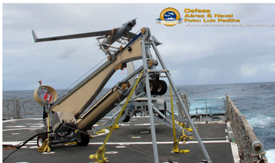
FIGURA 9 – ARP Scan Eagle sendo lançado de uma catapulta pneumática Compact Mark 4 posicionada no convôo do navio.
