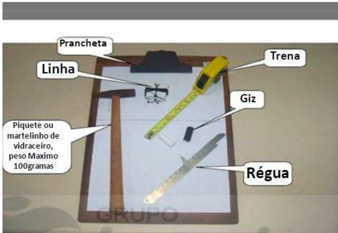
Figura 4 - Material usado na vistoria
