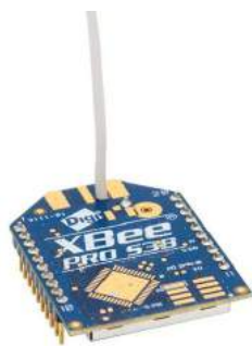
Figura 28 – Rádio XBee-PRO S3B (modelo XBP9BDMWT-012), com antena omnidirecional wire de 1.9 dBi . Fonte: (69).
