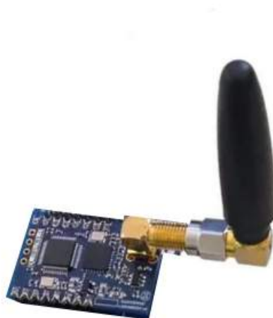
Figura 31 – Rádio LoRa RD42C, com antena omnidirecional de 2.15 dBi . Fonte: (43).
