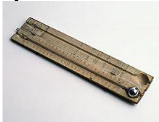
Figura 2: Termômetro de mercúrio
