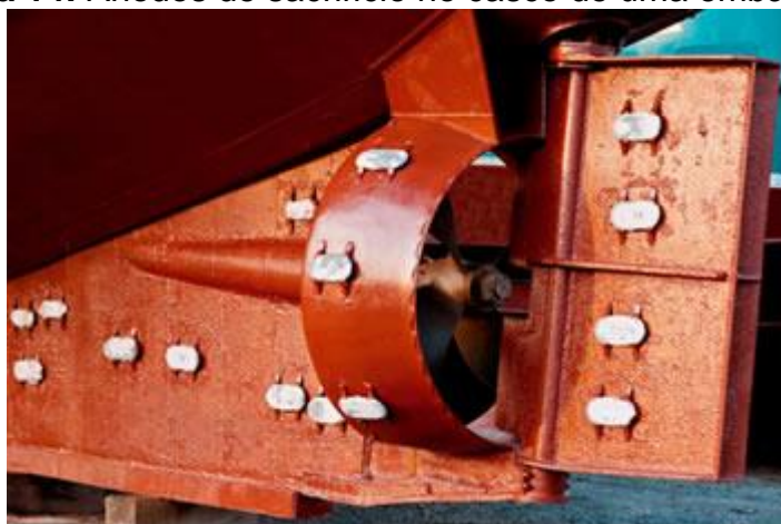
Figura 14: Anodos de sacrifício no casco de uma embarcação
