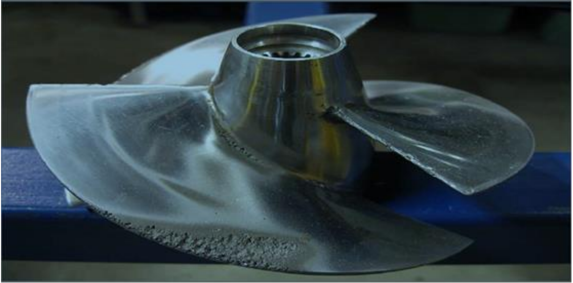
Figura 13: Exemplo de corrosão por cavitação em propulsor
