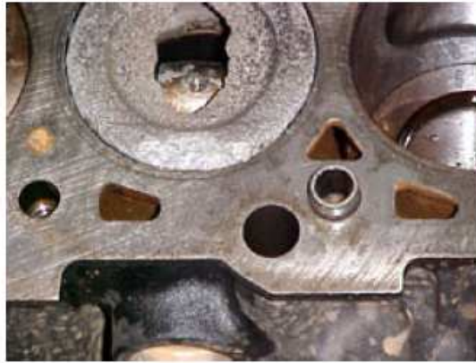
FIGURA 8 - Danificação por detonação
