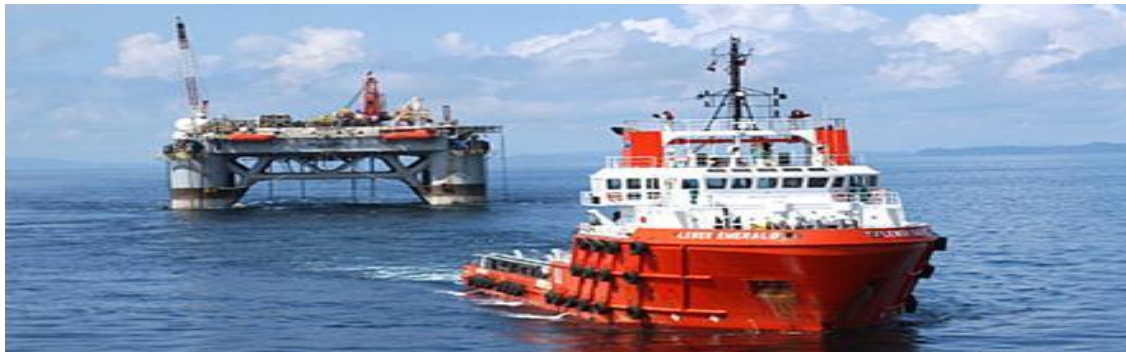
Figura 11 - AHTS rebocando plataforma
