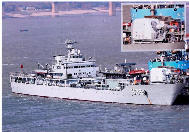
Figura 6 – *Railgun* chinês embarcado para realização de testes [8] .
