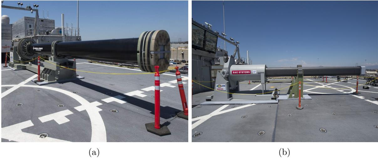
Figura 5 – Protótipos de *railgun* da (a) *General Atomic System* e da (b) *BAE System* [6].
