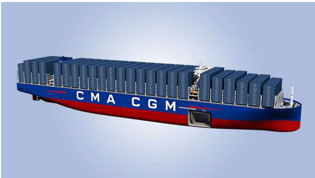
Figura 23 – Navio construído com “bulbless”, segundo WALCKETT, 2018.
