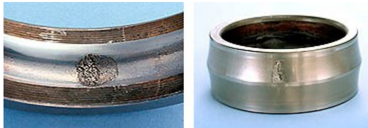
Figura 13: Rolamento danificado por fadiga
