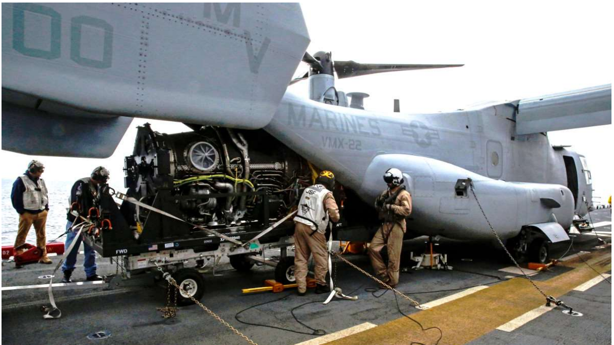
Figura 10 – Teste de carregamento do motor do F-35C no MV-22 Osprey dos USMC
