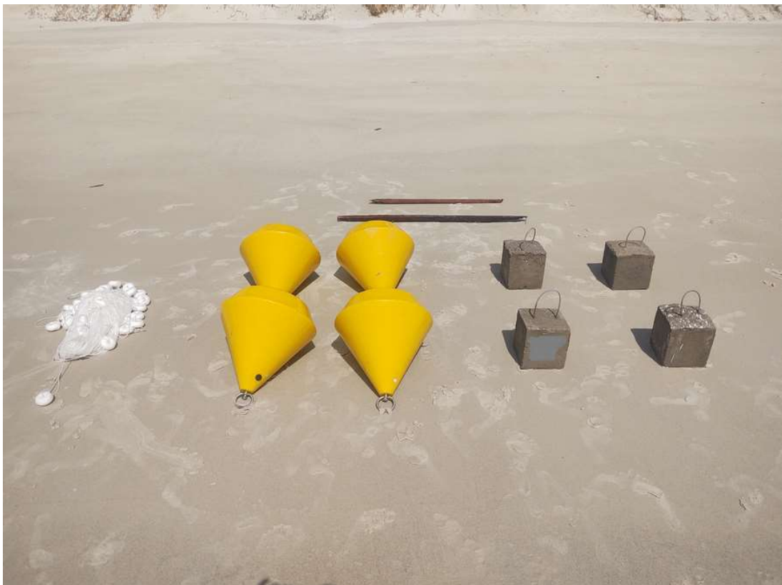
Figura 4 – Boias, postes e cabo de ligação para delimitação da área de sondagem
