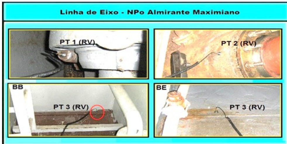
Figura 17–Fotografia dos pontos de medição dos mancais da linha de eixo.
