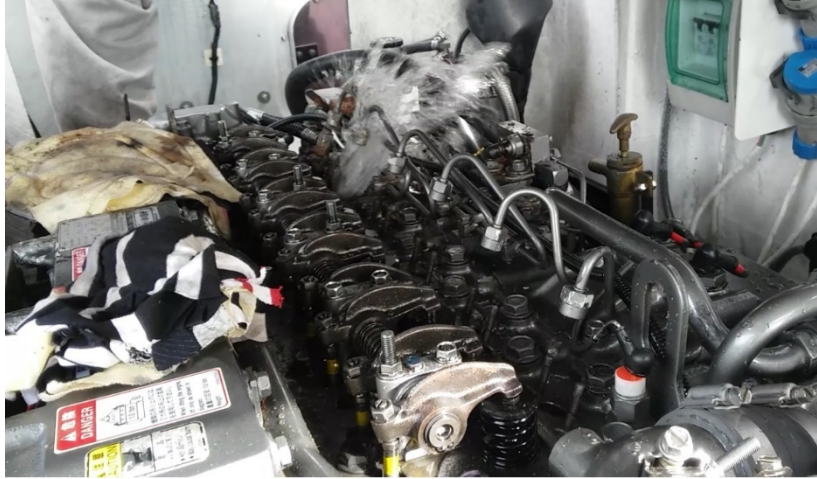
Figura 29 – Vista do Motor da lancha Pacific 24 aberto, após a avaria. Fonte: Própria (2016).
