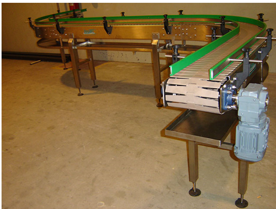
Figura 32 Esteira transportadora com roletes acionados
