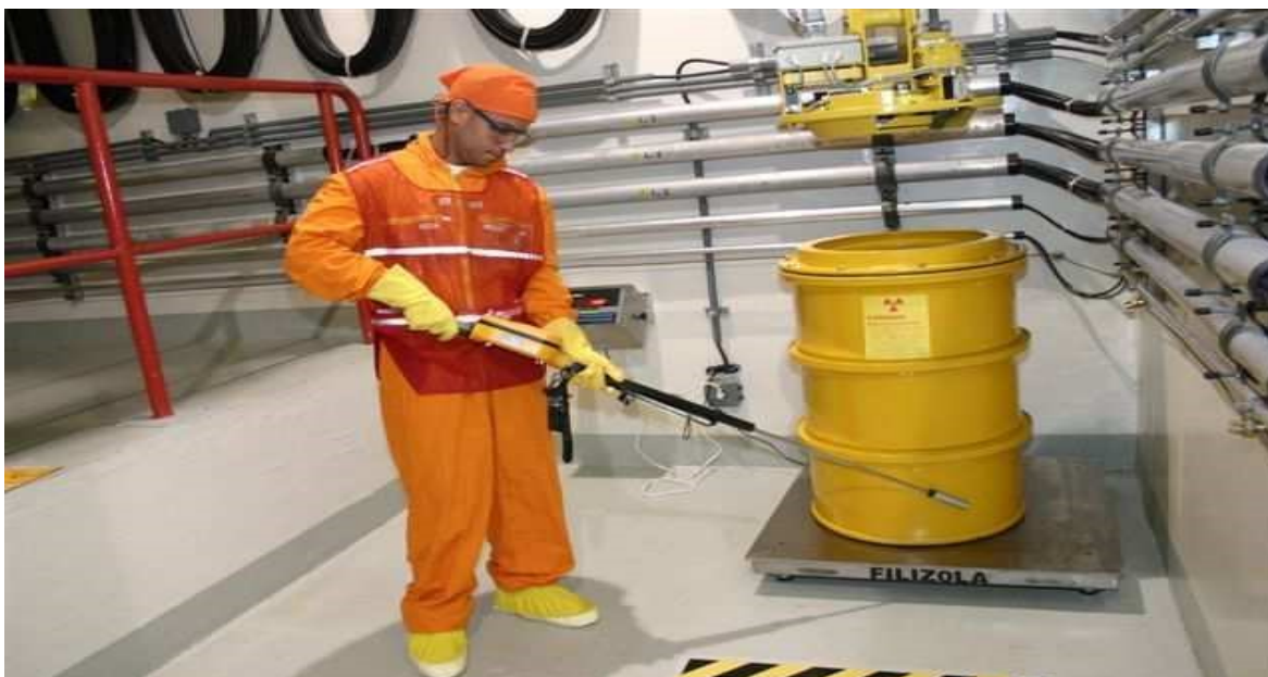
Figura 13 Monitoramento da radiação dos embalados de rejeitos de médio e baixo níveis de radiação
