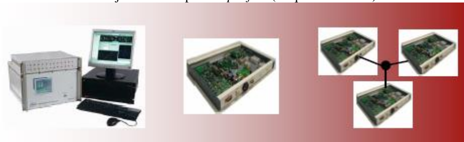
Figura 13: Ilustração de um Simulador GPS (ataque simples) à esquerda, receptor- spoofers (ataque intermediário) no centro e um conjunto de receptores- spoofers (ataque sofisticado) à direita
