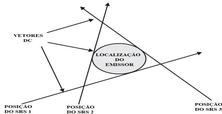
Figura 9 - Geometria da triangulação.
