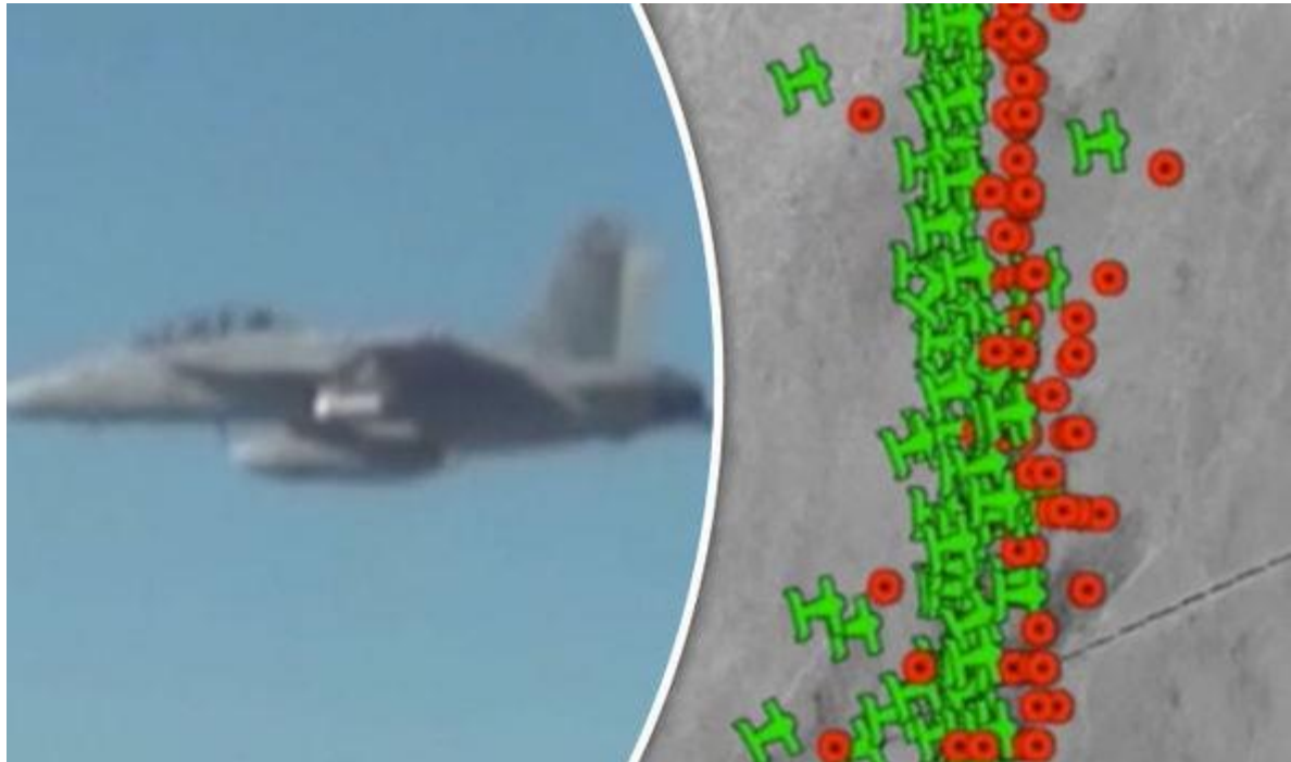
Figura 2.3 – Terceira Fase: enxame de drones; 103 unidades de mini drones Perdix lançados de um F/A-18 Super Hornet norte-americano num exercício em 2017 (WARREN, 2017).
