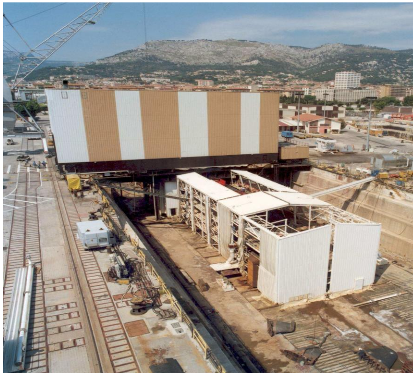
Figura 3 - Troca de Combustível com UMC durante PMG
