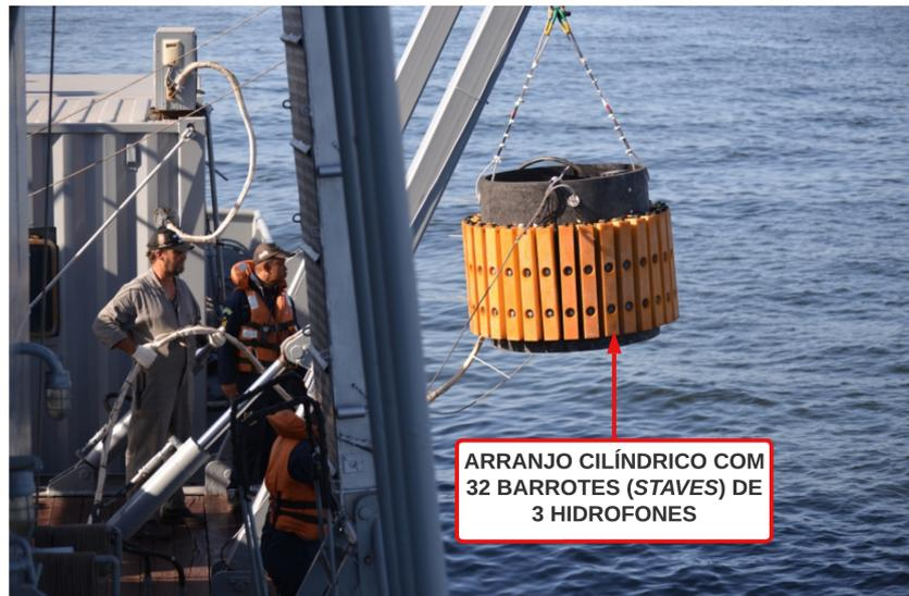
Figura 4.1: Arranjo cilíndrico de hidrofones - *Cylindrical Hydrophone Array* (CHA) com 32 barrotes (*staves*) de 3 hidrofones da comissão SONAP-I [9].
