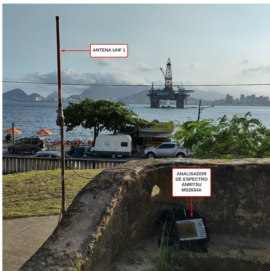
Figura 4.8: Estrutura utilizada para medição da perda de retorno da antena 1 (identificação 146035038).
