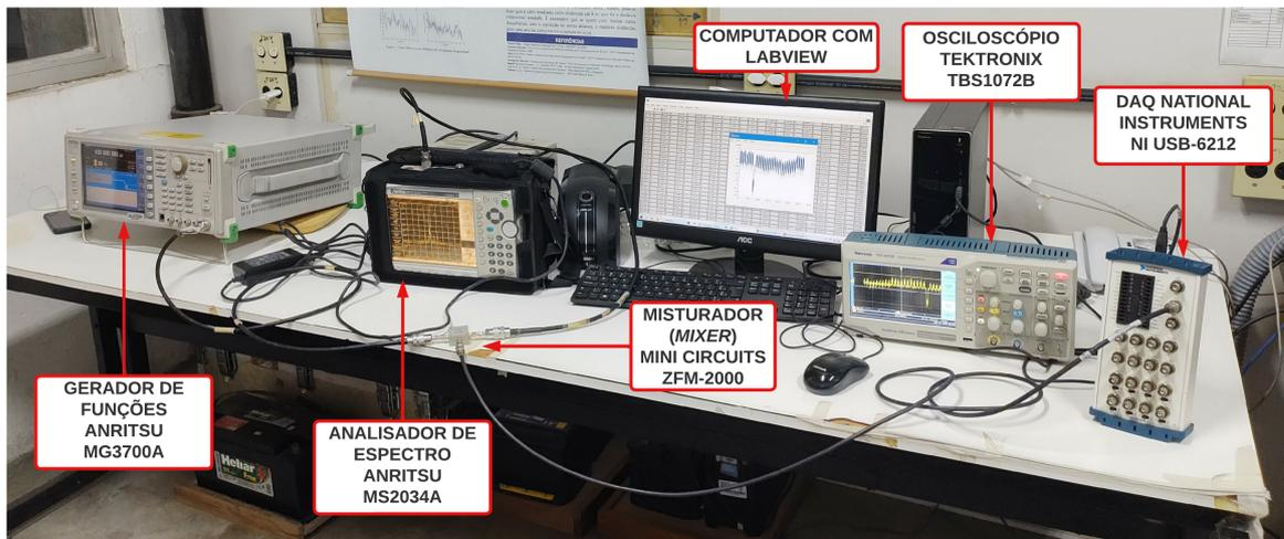
Figura 4.6: Montagem em laboratório para visualizar o espectro de frequência do sinal que chega à antena de transmissão.
