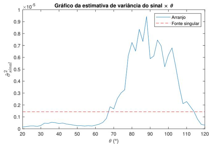
Figura 38 – Potência recebida pela transmissão da fonte singular e do arranjo a uma taxa de 400 bps.
