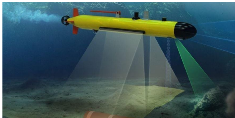
Figura 23 – Exemplo de AUV engajado na busca de ameaças subaquáticas no leito marinho
