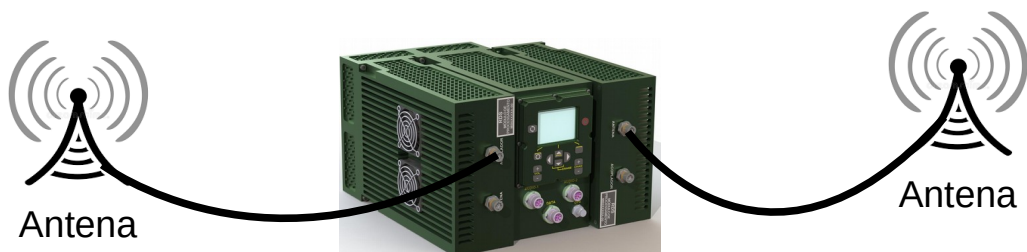
FIGURA 14 – O RDS-Defesa com duas interfaces de RF: dois rádios independentes em uma única plataforma física.
