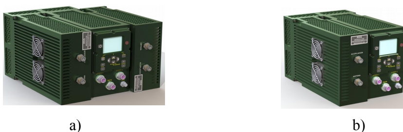
FIGURA 12 – O protótipo veicular do RDS-Defesa. a) Com duas interfaces de RF. b) Com apenas uma interface de RF.
