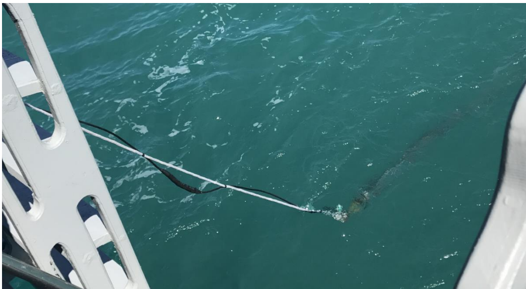
Figura 27 - Cabo de reboque trincafiado com o cabo elétrico durante a inserção do protótipo no mar
