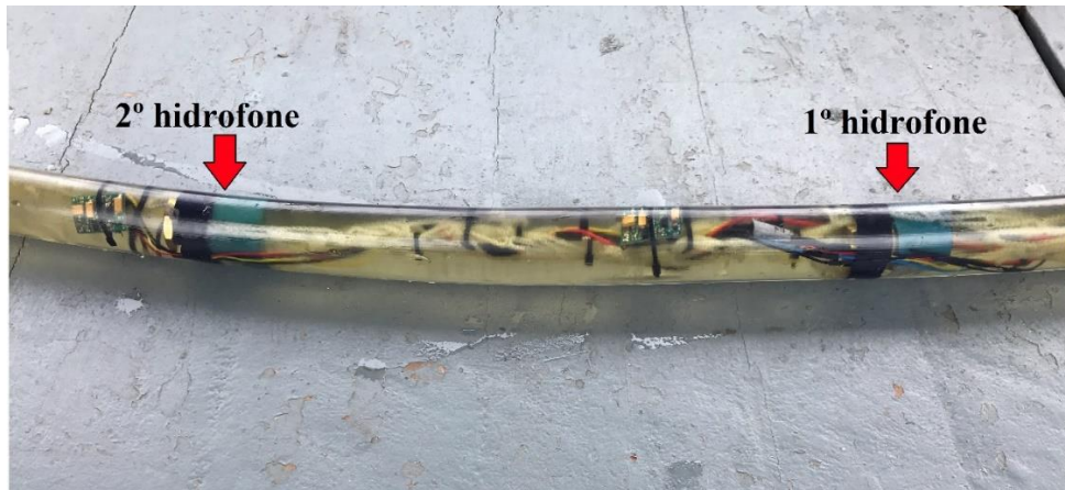
Figura 22 - Espaçamento entre os hidrofones
