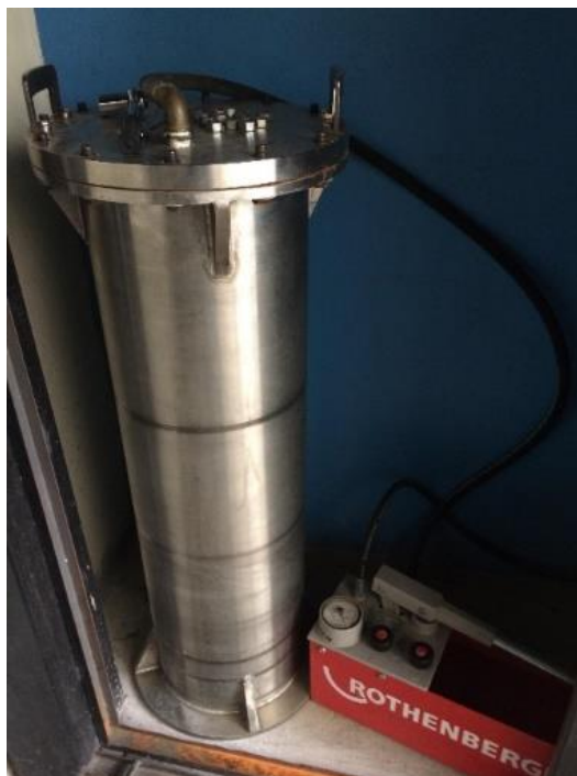
Figura 45 - Tanque para testes de estanqueidade
