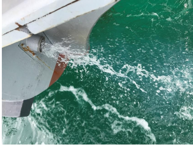
Figura 51 - Esgotamento de água da embarcação, um dos responsáveis pela geração de ruído
