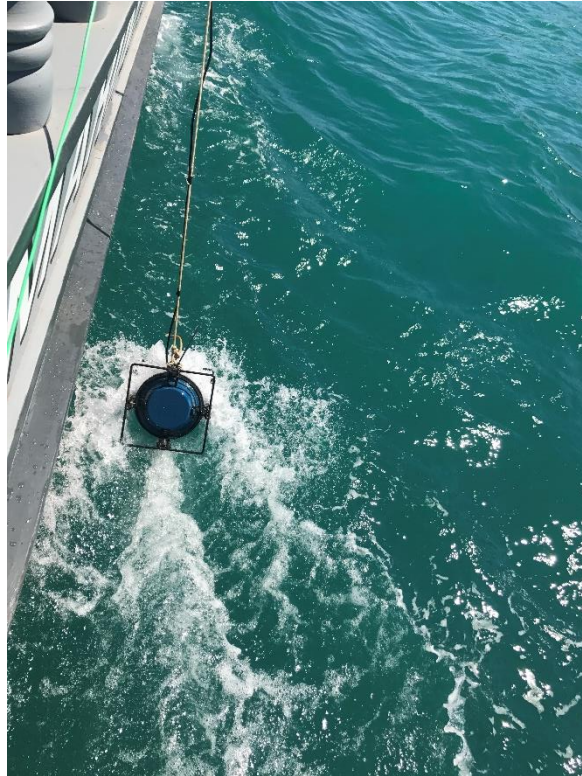
Figura 52 - Fonte acústica sendo colocada no mar pelo lado direito da embarcação
